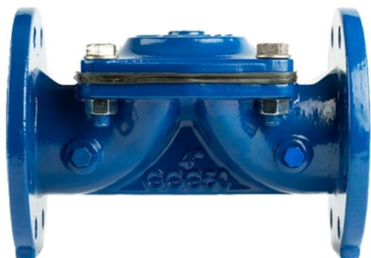
La vanne hydraulique en fonte FLUM VALVES est une vanne hydraulique à membrane de type SANDERS à chambre unique, avec une opération basique d'ouverture et de fermeture due à la pression exercée par l'eau dans la canalisation.
