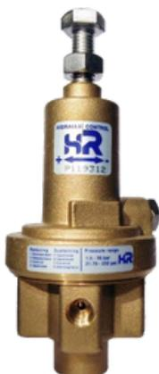
Il s'agit d'un pilote de régulation de pression à 3 voies qui est connecté comme système de contrôle à la vanne hydraulique, dont la fonction est de réguler la pression et en fonction de son installation, il peut transformer votre vanne en réducteur de pression ou en maintien. Il peut également être utilisé comme limiteur, pilote de secours, etc.
