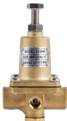
Le pilote modèle 123HR dispose de la fonction de réduction de pression à 2 voies agissant par le diaphragme, qui est en position ouverte étant donné la pression du ressort qui agit sur le diaphragme. Lorsque la pression en aval de la vanne dépasse le point réglé, le débit d'eau est fermé, réalisant ainsi une régulation de pression.
