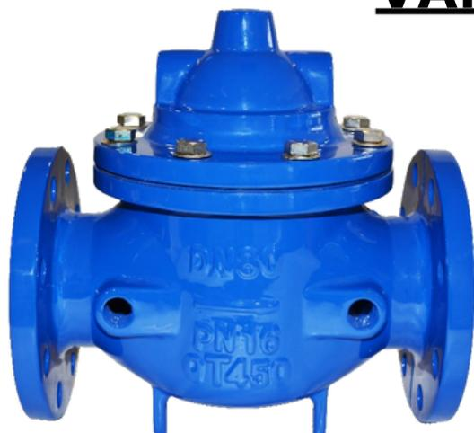
La vanne hydraulique en fonte FLUM VALVES est une vanne hydraulique à fermeture rigide avec un piston guidé à chambre unique, avec une opération basique d'ouverture et de fermeture due à la pression exercée par l'eau dans la canalisation.
