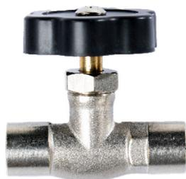
La válvula de aguja es llamada así por el vástago cónico que hace de obturador sobre un orificio de pequeño diámetro. Puede funcionar como racor de restricción, pero con la posibilidad de regular el estrangulamiento en la sección de paso.
