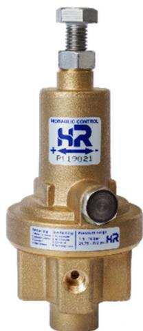
Es un piloto limitador 3 vías que se conecta como sistema de control a la válvula hidráulica. Esta formado por el cuerpo de plástico con conexiones de 3 vías, un muelle ajustable mediante el tornillo y un diafragma.
