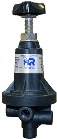
Es un piloto regulador de 3 vías que se conecta como sistema de control a la válvula hidráulica, cuya función es regular la presión y en función de su instalación puede convertir tu valvula en reductora o sostenedora de presión.
