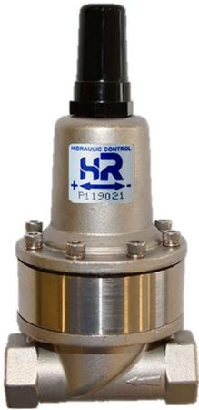
El piloto sostenedor de acero inoxidable de 2 vías tiene la función de mantener la presión aguas arriba de la válvula actuando por diafragma, el cual se encuentra en posición de abierto dada la presión del muelle que actúa sobre el diafragma. Cuando la presión aguas arriba de la válvula es inferior a la tarada, la válvula permanece cerrada.
