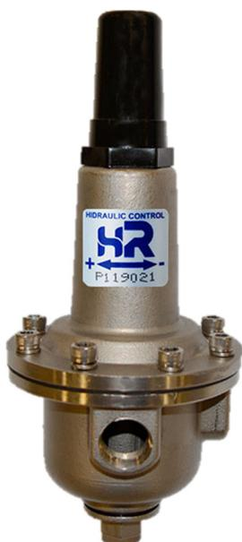
El piloto reductor de acero inoxidable de 2 vías tiene la función de reducción de presión actuando por diafragma, el cual se encuentra en posición de abierto dada la presión del muelle que actúa sobre el diafragma. Cuando la presión aguas abajo de la válvula supera el punto regulado, se cierra el paso de agua, consiguiendo de este modo la regulación de presión.
