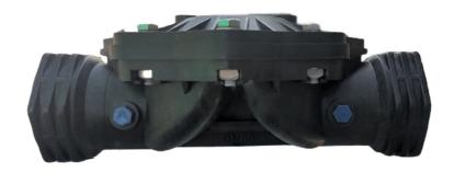
La válvula hidráulica de plástico FLUM VALVES, es una válvula hidráulica de diafragma tipo SANDERS con cámara simple, con un funcionamiento básico de apertura y cierre debido a la presión que ejerce el agua existente en la conducción.
