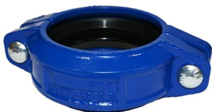
Diseñado para la unión de extremos ranurados. Proporciona una unión autocentrada y evita el uso de soportes especiales y juntas de expansión.
