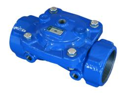
La válvula hidráulica de fundición FLUM VALVES, es una válvula hidráulica de diafragma tipo SANDERS con cámara simple, con un funcionamiento básico de apertura y cierre debido a la presión que ejerce el agua existente en la conducción.
