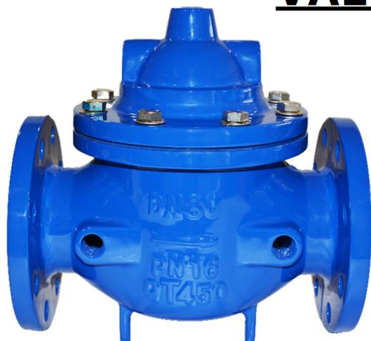
La válvula hidráulica de fundición FLUM VALVES, es una válvula hidráulica de cierre rígido por pistón guiado con cámara simple, con un funcionamiento básico de apertura y cierre debido a la presión que ejerce el agua existente en la conducción.
